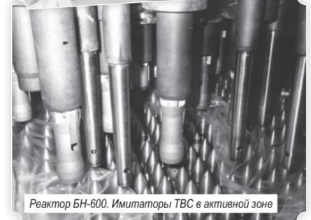
Реактор БН-600. Имитаторы ТВС в активной зоне
