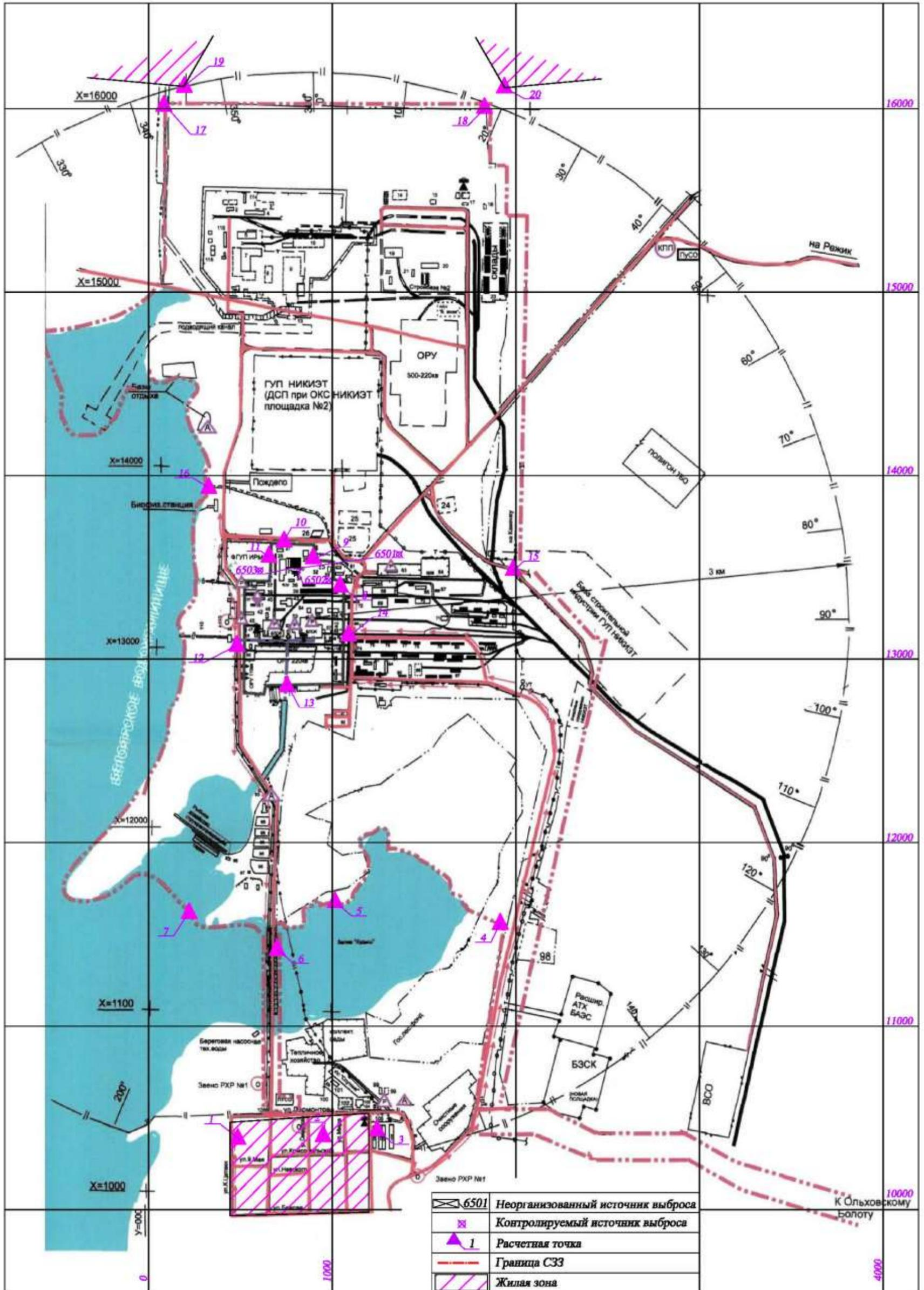
Рисунок 8.2.2.1.1 – Карта-схема объекта. Источники выбросов загрязняющих веществ в период строительства
