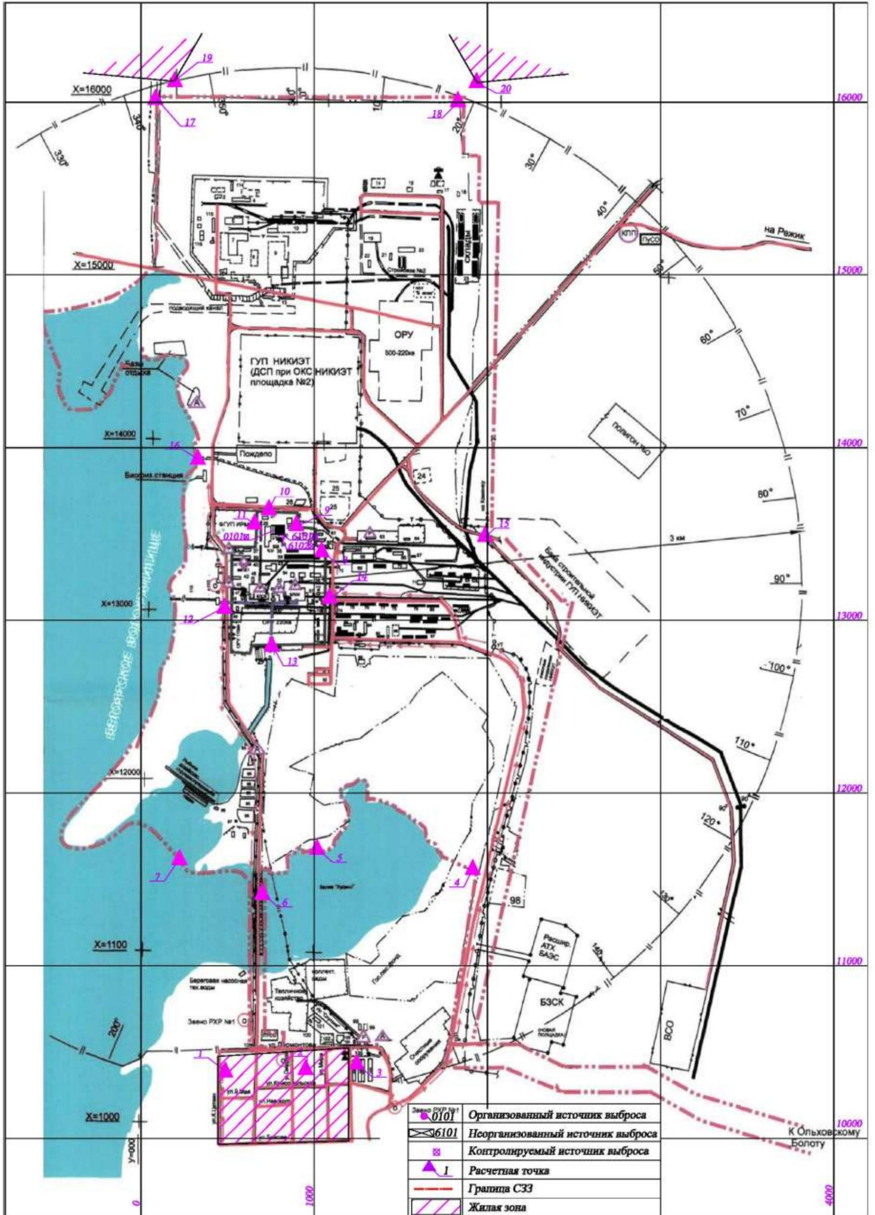
Рисунок 8.2.2.1.1 – Карта-схема объекта. Источники выбросов загрязняющих веществ в период эксплуатации
