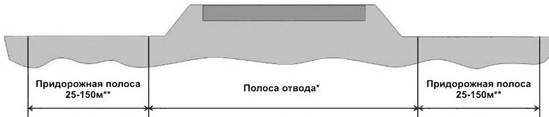
\* Границы полосы отвода автомобильной дороги зависят от категории автомобильной дороги, количества полос движения, высоты насыпей или глубины выемок, наличия боковых резервов, крутизны откосов земляного полотна, требований обеспечения безопасности движения и боковой видимости, а также других условий.
