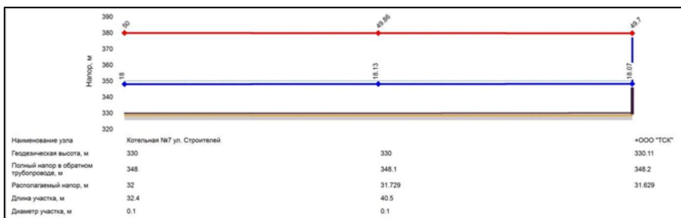
Рисунок 7. Пример пьезометрического графика
