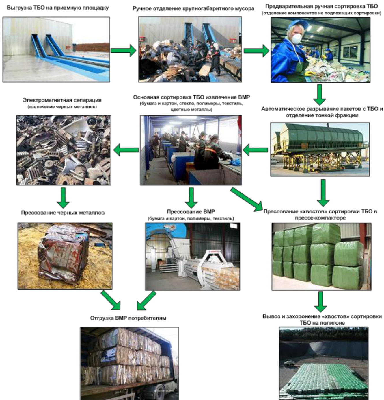
Рис. 6.1. Технологическая схема мусоросортировочного комплекса
