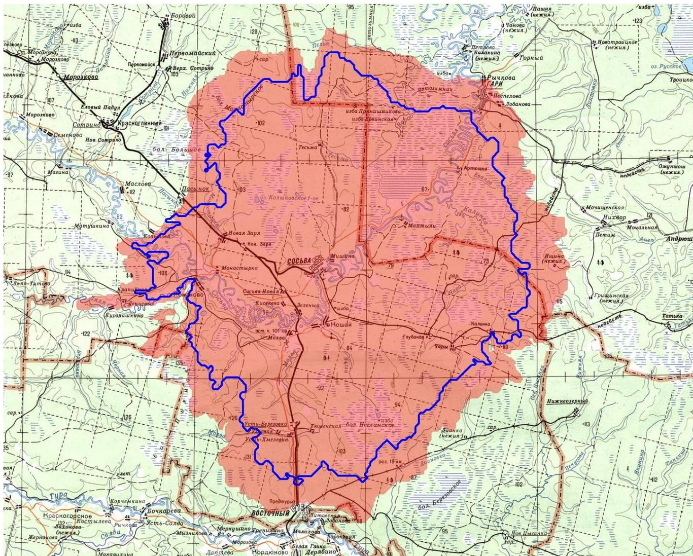
**Синий контур (действующий вариант):**  $K_{ус}$  антенны = 11 дБд,  $H_{подвеса}$  антенны = 78 м.
