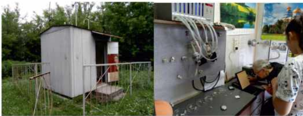
Рис.4. Стационарный пост наблюдения загрязнения атмосферного воздуха.
