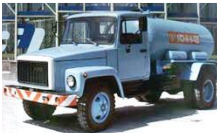
Рисунок 21 - Вакуумная машина КО-503В
