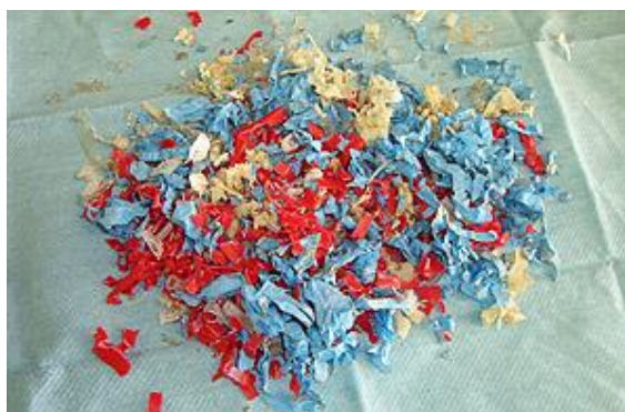
Рисунок 18 - После обработки - стерильные неидентифицируемые отходы
