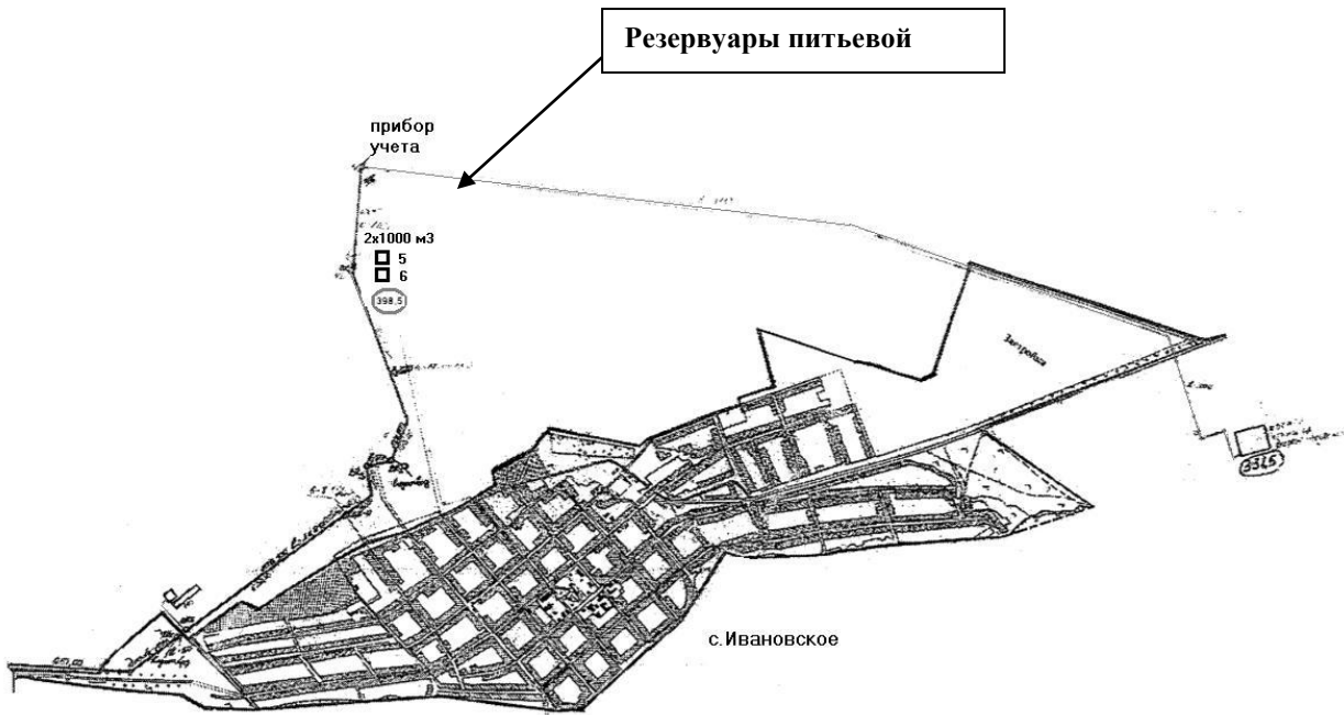
рисунок 2 Схема расположения магистрального водопровода и резервуаров питьевой воды (с.Ивановское)
