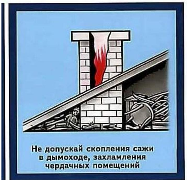
Одной из основных причин пожаров в индивидуальных жилых домах и надворных постройках является нарушение правил устройства и эксплуатации печного отопления. Как показывает анализ произошедших пожаров – каждый третий пожар происходит по причине неисправности отопительной печи или ее не правильной эксплуатации.
