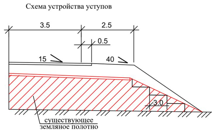
1. Поперечные профили земляного полотна запроектированы в соответствии с типовыми материалами для проектирования 503 - 0 - 48.87 "Земляное полотно автомобильных дорог общего пользования".
