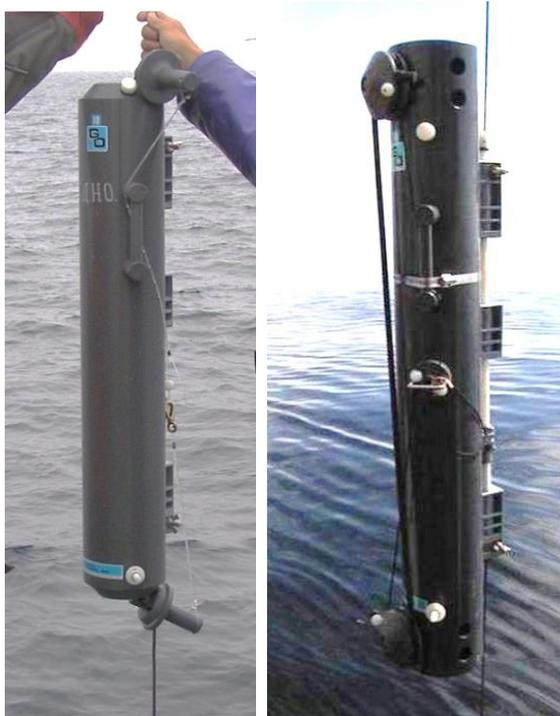
Рис. 9.14 Батометры типа Нускина (слева) и типа Go Flo (справа)
