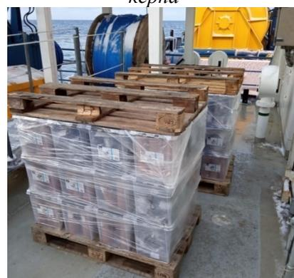
*Рис. 7.5. Пример упаковки образцов керна для отправки в лабораторию*
