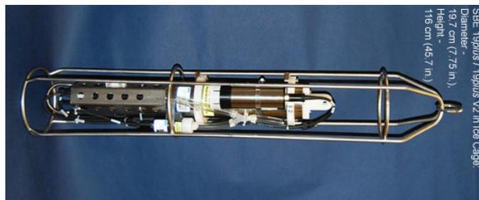
Рис. 9.12 Гидрологический зонд SBE-19+
