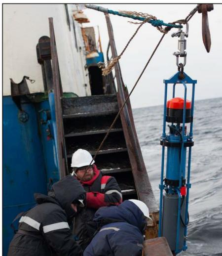
Рис. 9.11 Постановка АБС с акустическим доплеровским профилографом течений RDCP 600 SW
