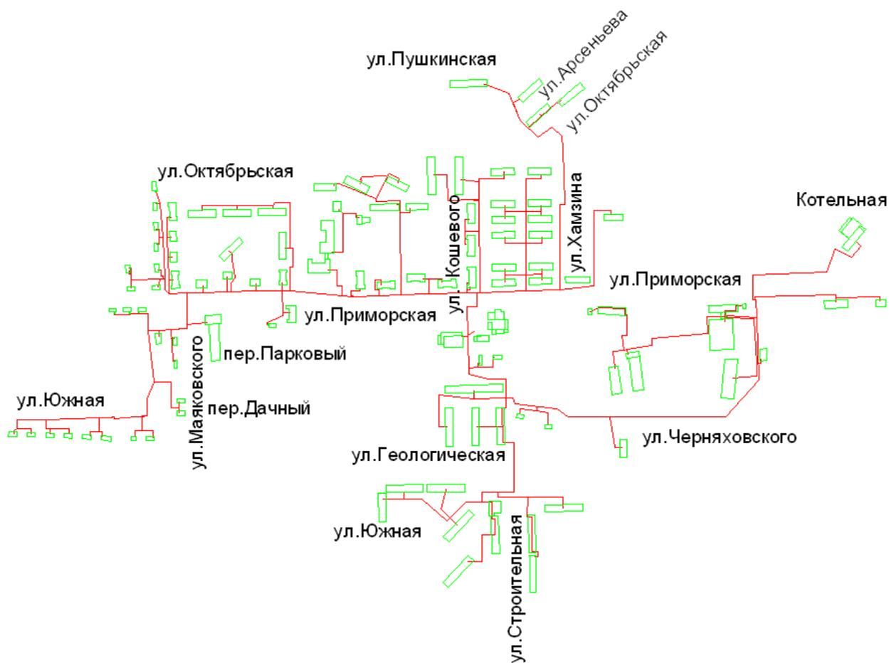
Рис. 6 – Схема тепловых сетей (зона №2) от Гореловской котельной до потребителей
