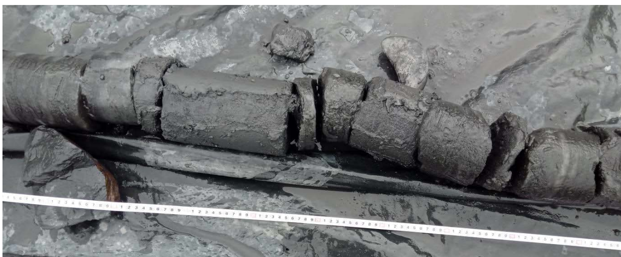
Рисунок 5 – Песок пылеватый, твердомерзлый, льдистый.
