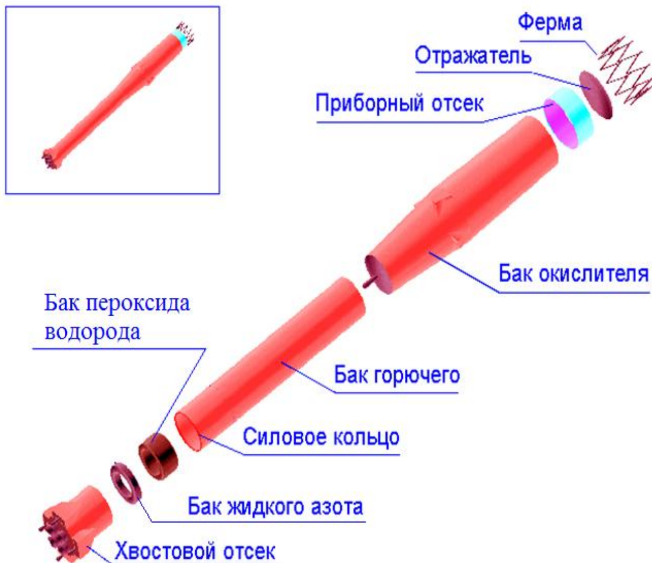
Рисунок 3.1 – Конструкция ЦБ РН «Союз-2»
