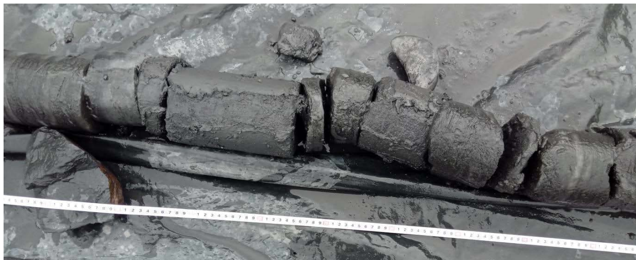
Рисунок 3 – Песок пылеватый, твердомерзлый, льдистый
