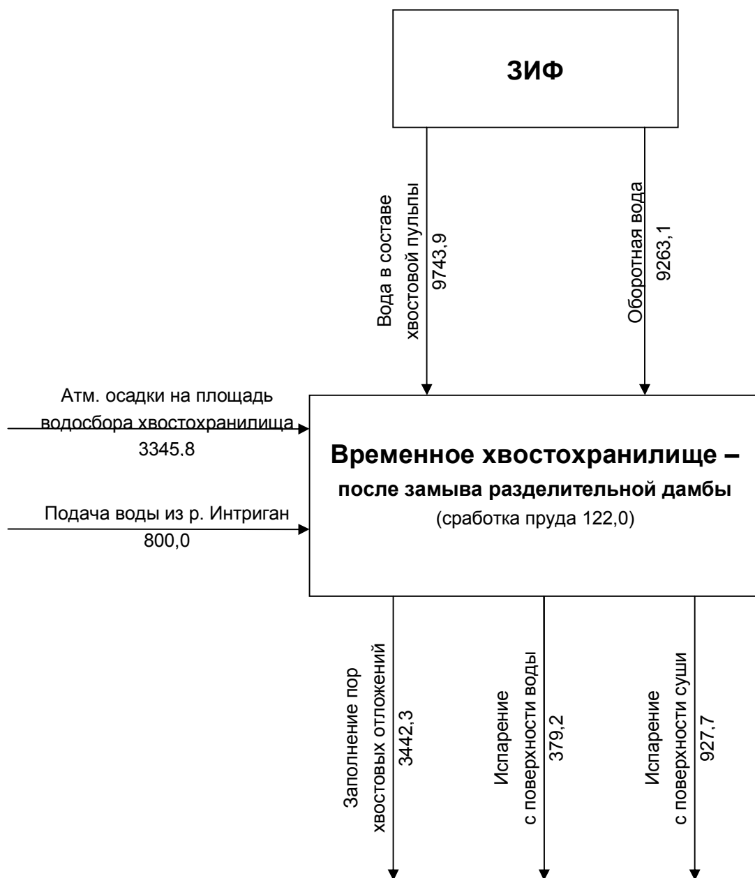
Рисунок 6.2.2 — Схема оборотного водоснабжения ЗИФ из временного хвостохранилища после замыка разделительной дамбы для среднего по водности года (2017 г.)
