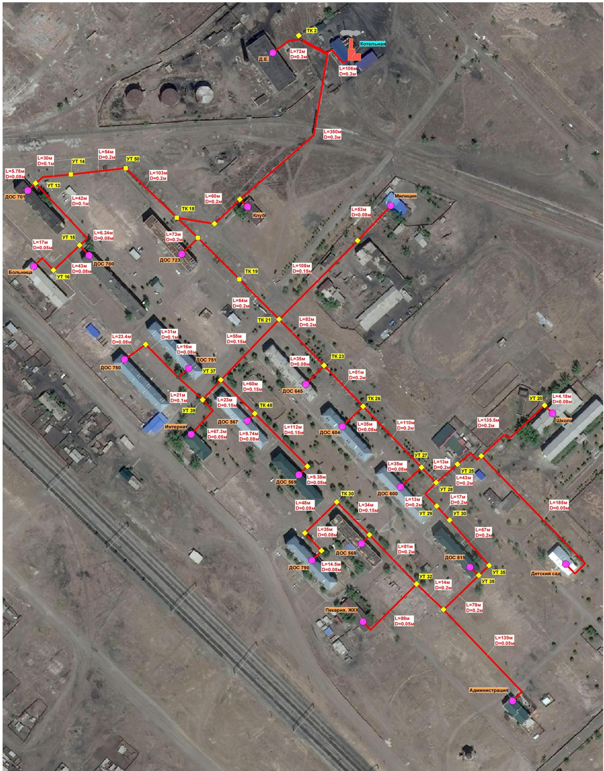
Рис. 2.2 – Схема теплоснабжения посёлка Даурия.
