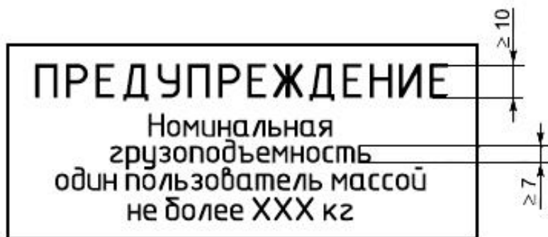
Рисунок 6 - Образец стандартной надписи с информацией о грузоподъемности
