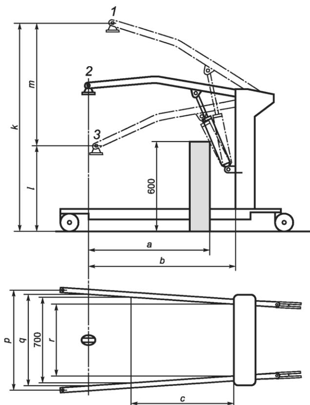
1 - положение максимального подъема; 2 - максимально допустимое положение; 3 - самое низкое положение; a - максимальная область досягаемости при 600 мм (контрольная высота); b - максимальная область досягаемости от основания; c - область досягаемости от основания при ногах, расставленных на расстояние
