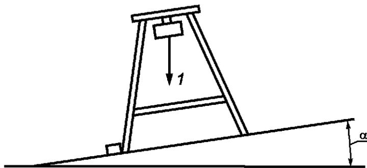
1 - испытательная нагрузка;  $\alpha$  - угол устойчивости =  $10^\circ$
