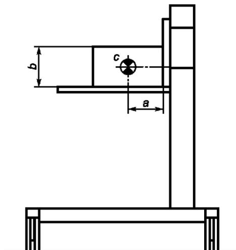
a - ширина в миллиметрах = 2 x максимальная нагрузка в килограммах; b - высота = 200 мм; c - центр тяжести
