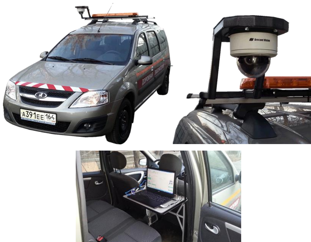
Рисунок 1 – Измерительный комплекс – передвижная дорожная лаборатория КП-514СМП на базе автомобиля «LADA Largus»
