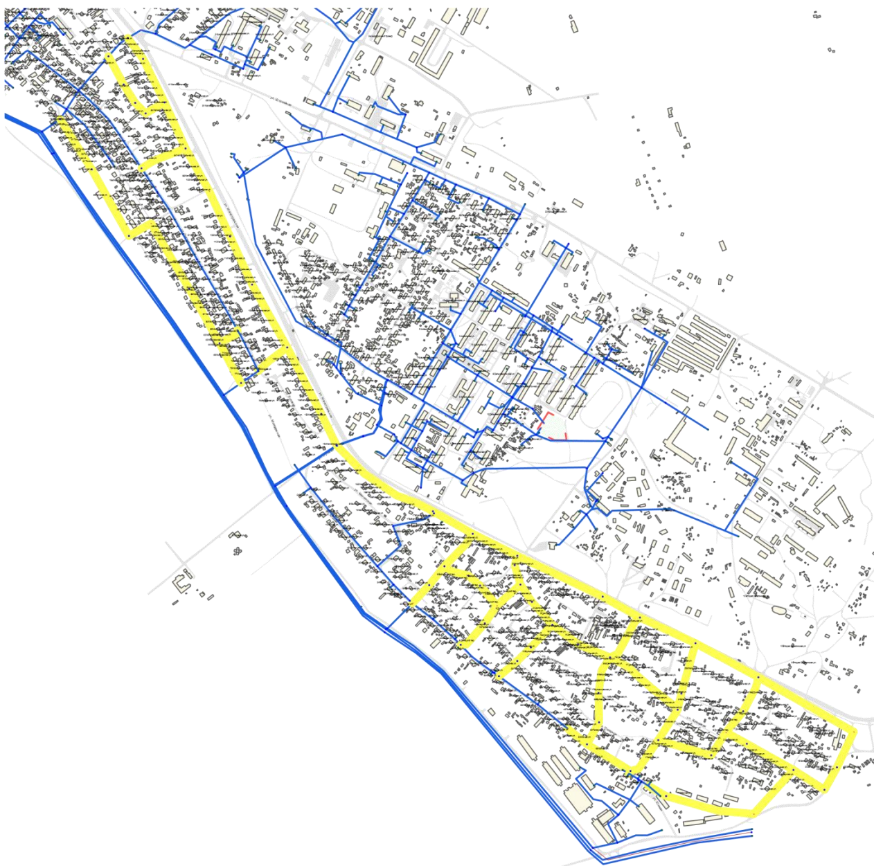
Рисунок 7.11. Новое строительство сетей водоснабжения мкр. Южный
