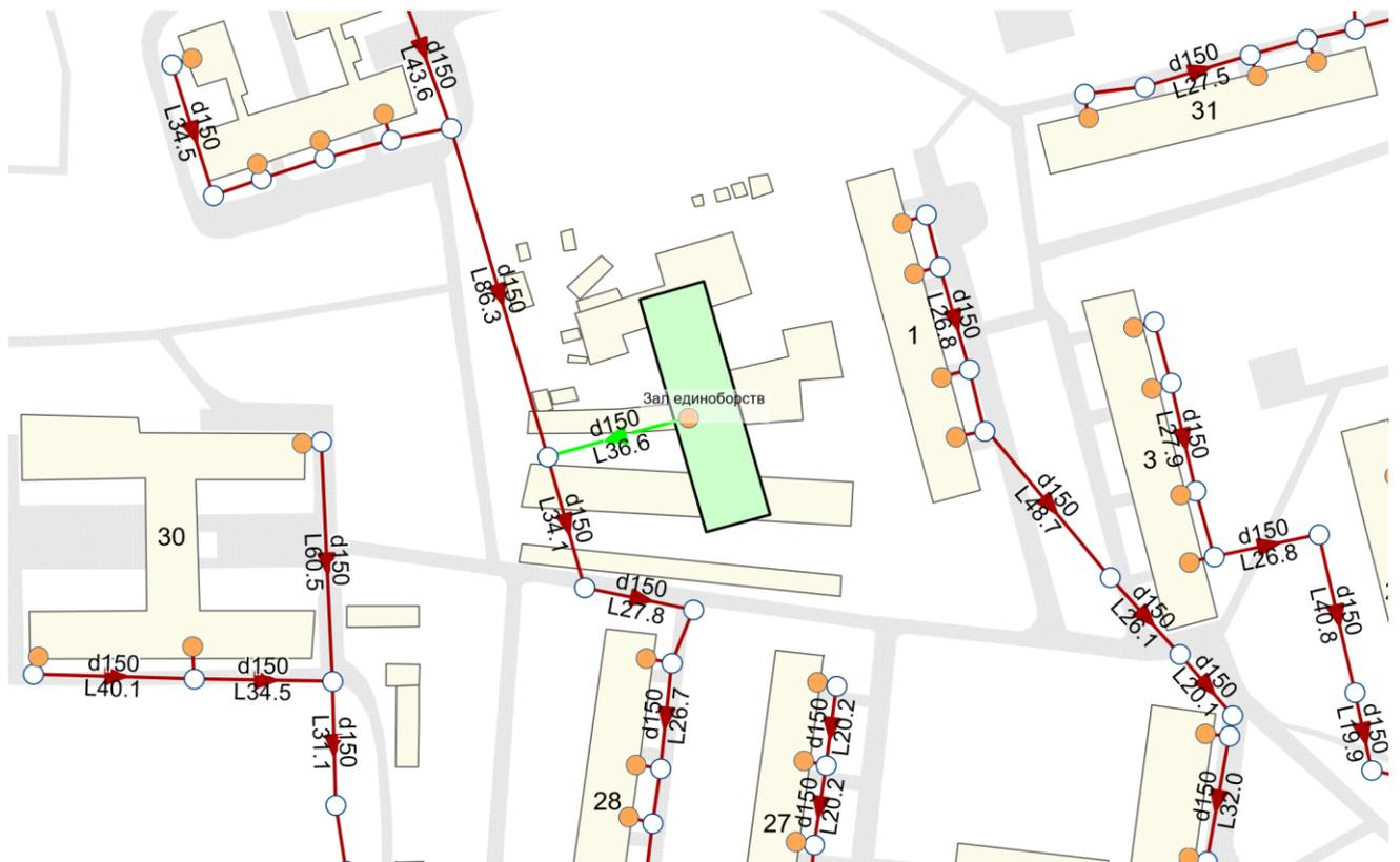
Рисунок 4.13. Строительство сетей водоотведения для подключения объекта «Здание зала единоборств».
