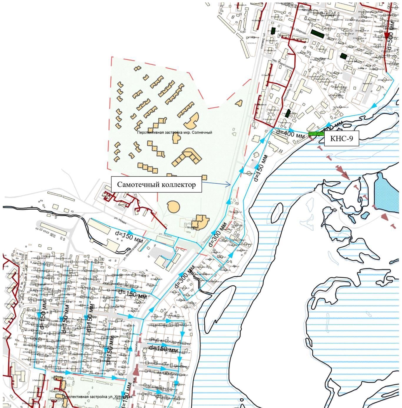
Рисунок 4.38. Расположение самотечного коллектора к КНС-9 в модели
