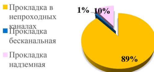
Рисунок 2.9. Сети отопления по способу прокладки
