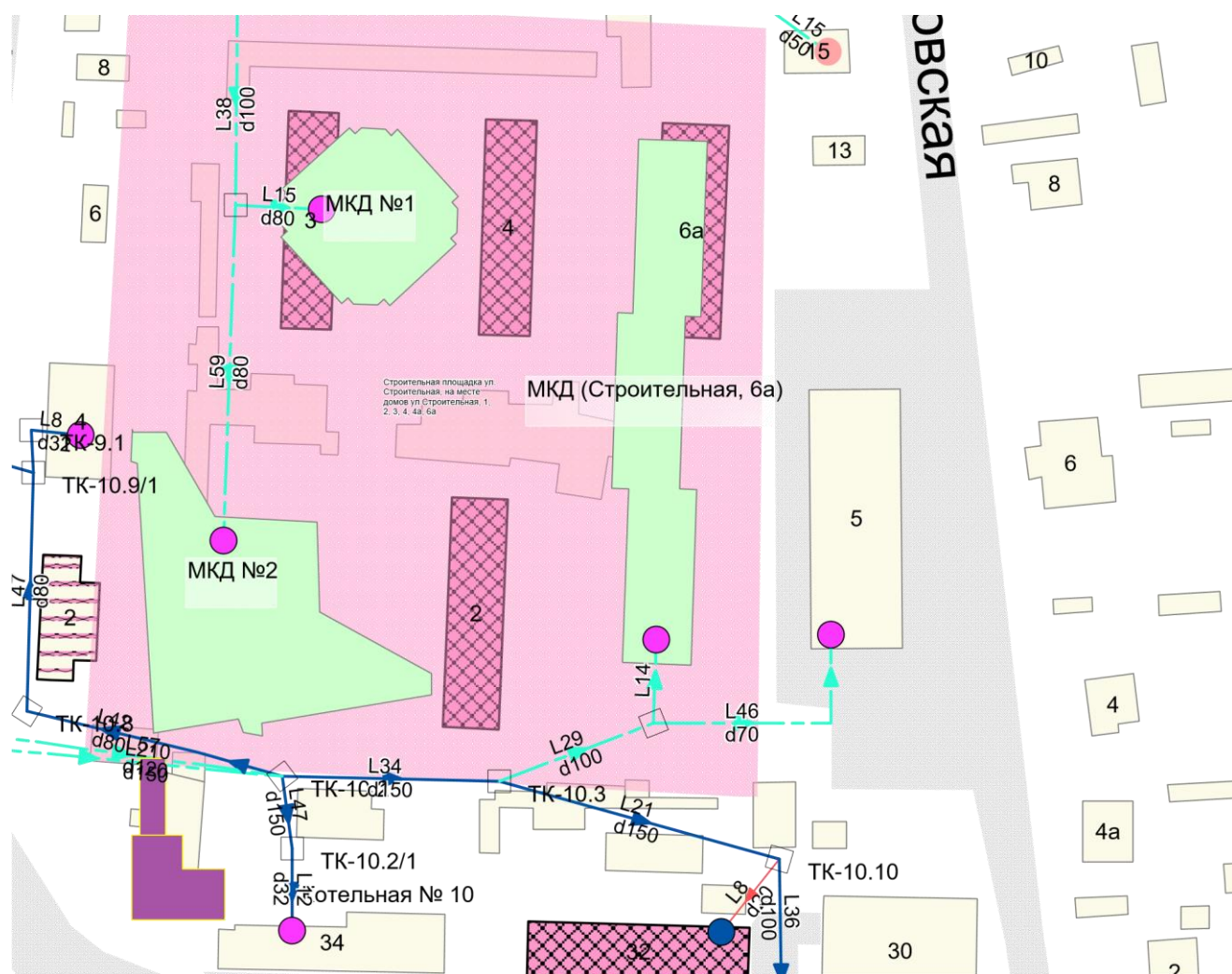
Рисунок 5.14. Строительная площадка ул. Строительная, на месте домов ул. Строительная, 1, 2, 3, 4, 4а, 6а – Подключение МКД (Строительная, 6а)
