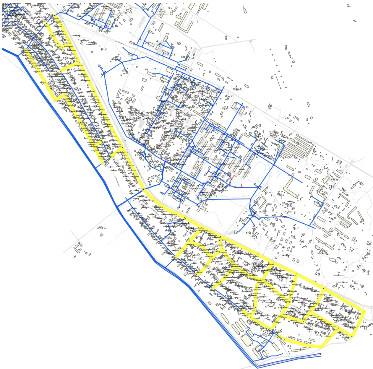
Рисунок 7.10. Новое строительство сетей водоснабжения мкр. Южный
