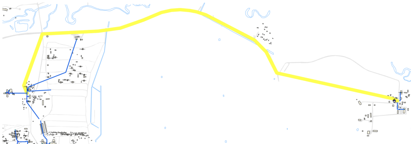
Рисунок 7.21. Трасса водовода 2d100 от мкр. Заречный на мкр. Мутной
