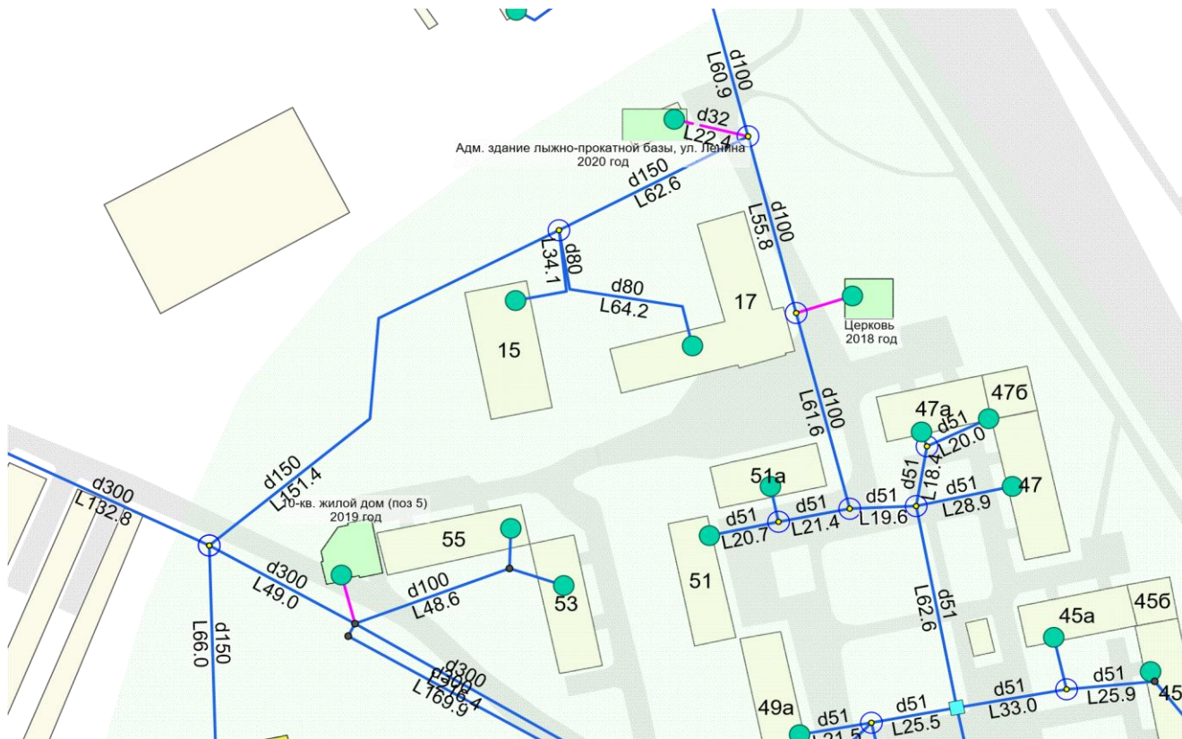
Рисунок 6.9. Подключение 10-квартирного жилого дома (поз.5), здания лыжно-прокатной базы и здания церкви
