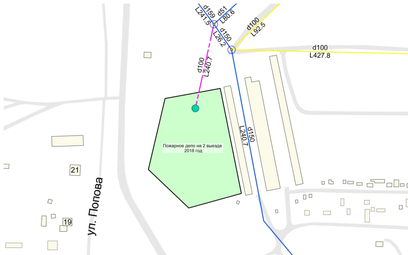
Рисунок 6.31. Подключение объекта "Пожарное депо на 2 выезда" ул. Попова
