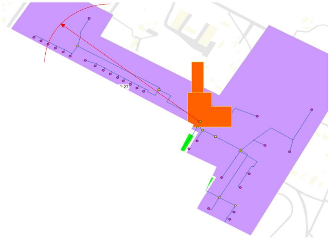
Рисунок 2.3. Радиус эффективного теплоснабжения котельной № 27
