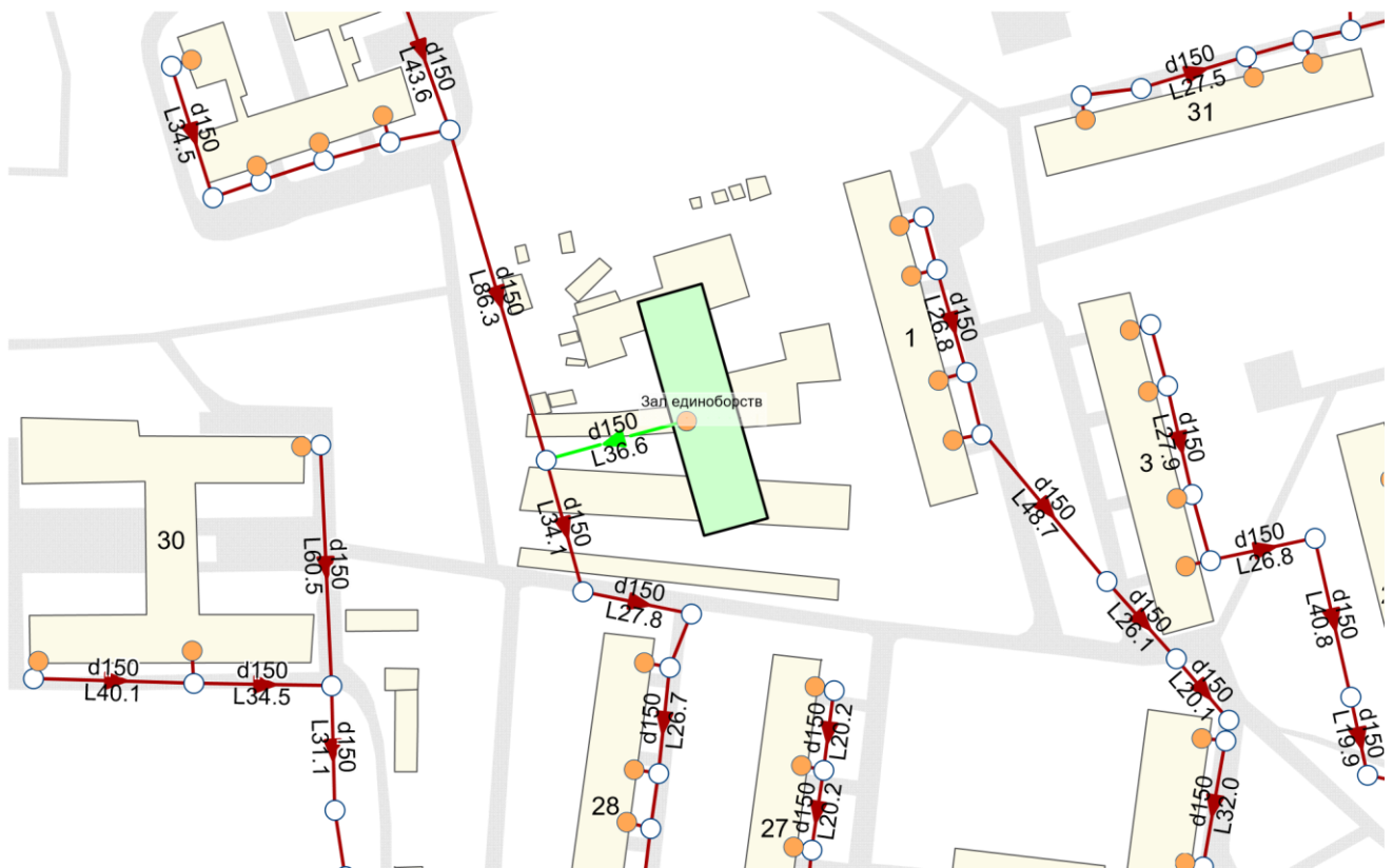
Рисунок 4.5. Строительство сетей водоотведения для подключения объекта "Здание единоборств".
