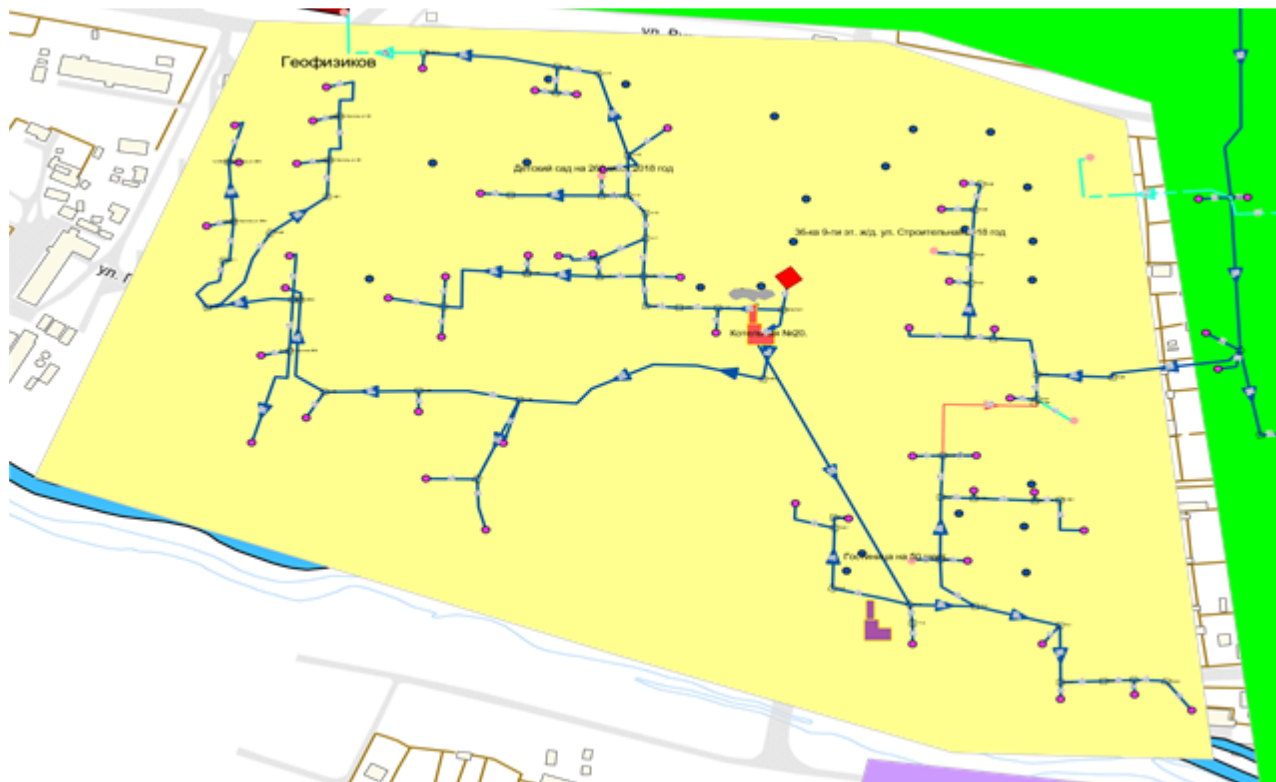
Рисунок 4.3. Зона действия котельной № 20 (объединение нагрузок от котельной № 10) реконструкция котельной № 18 (ул. Нагорная) с увеличением мощности до 10,5 Гкал/ч с передачей нагрузок котельной № 17 в 2020 г. (рис. 4.4);
