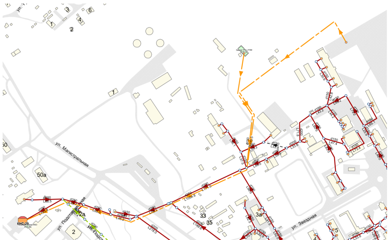
Рисунок 4.21. Строительство самотечного коллектора для проектируемого аэровокзального комплекса аэропорта г. Петропавловск-Камчатский, подключение объекта Здание ПРЦ с РЭМ
