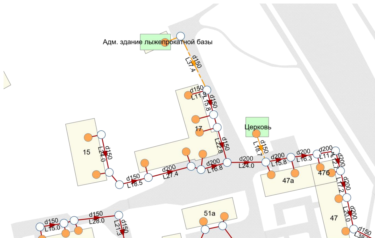
Рисунок 4.12. Строительство сетей водоотведения для подключения объектов «Административное здание лыжепрокатной базы», «Церковь ул. Ленина».
