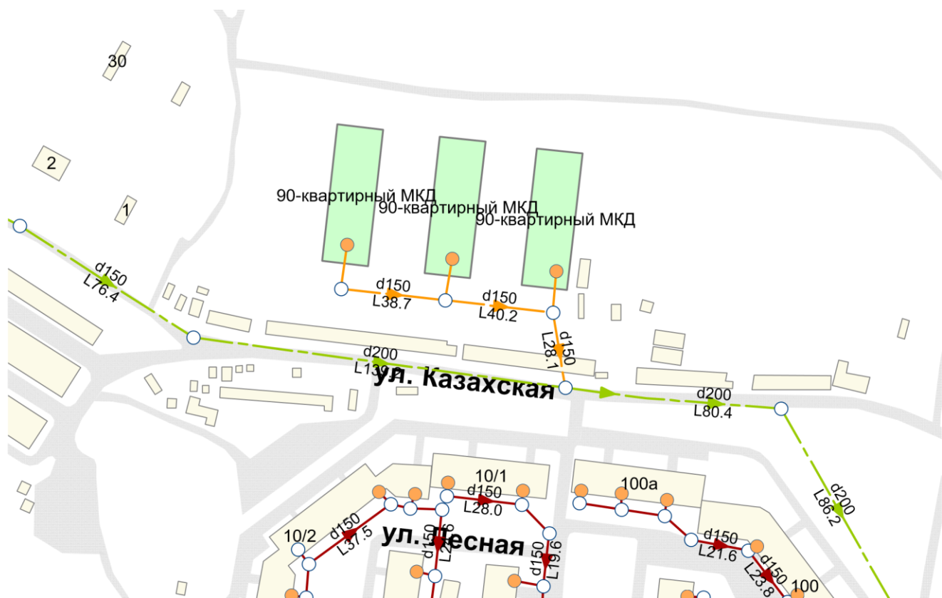
Рисунок 4.27. Подключение объектов «9-этажные 90-квартирные жилые дома по ул. Казахская – 3 шт.»
