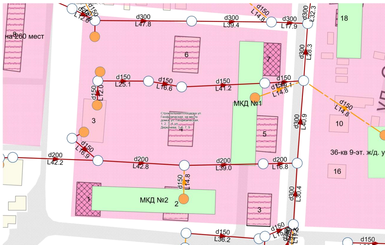
Рисунок 4.6. Строительство сетей водоотведения для подключения объектов МКД №1, МКД №2
