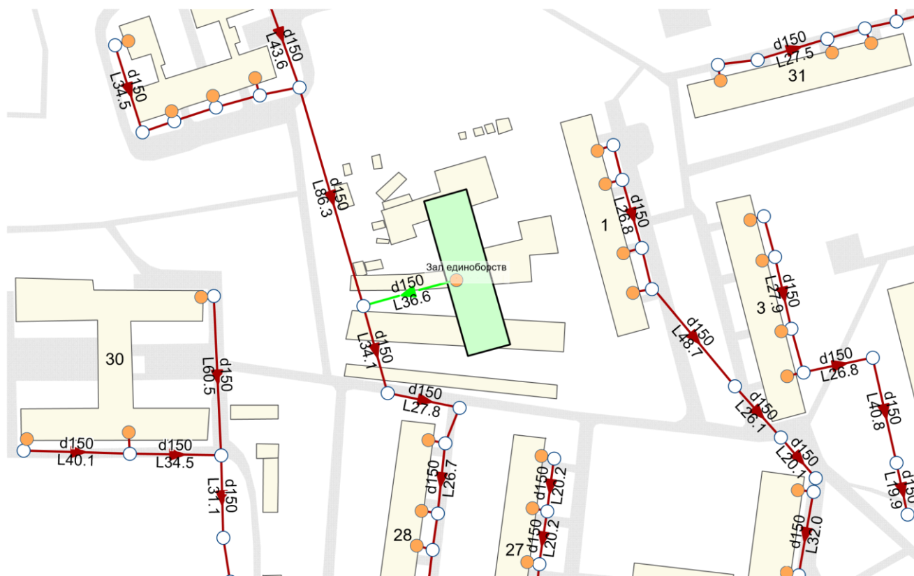
Рисунок 4.13. Строительство сетей водоотведения для подключения объекта «Здание зала единоборств».
