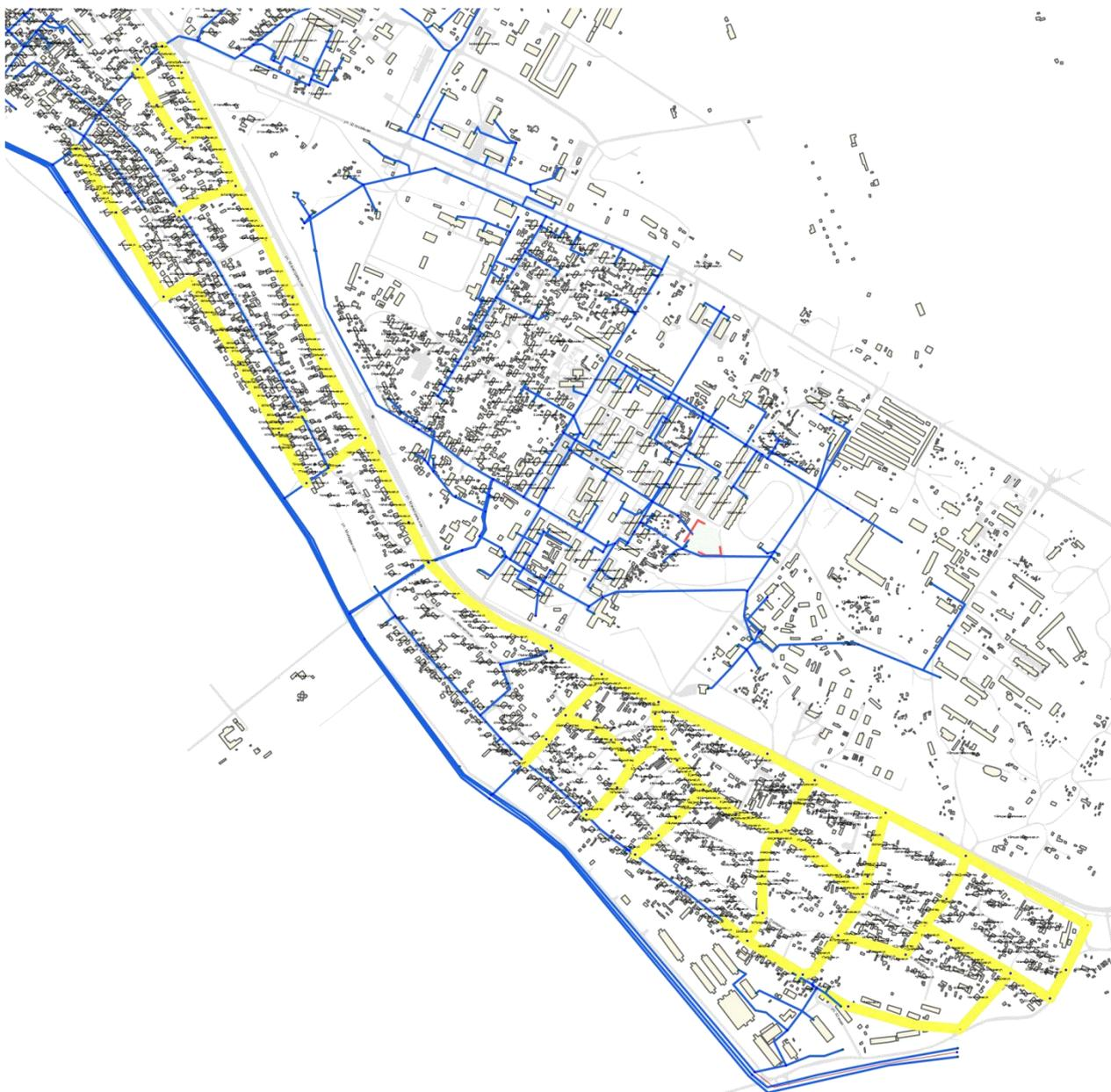
Рисунок 7.9. Новое строительство сетей водоснабжения мкр. Южный
