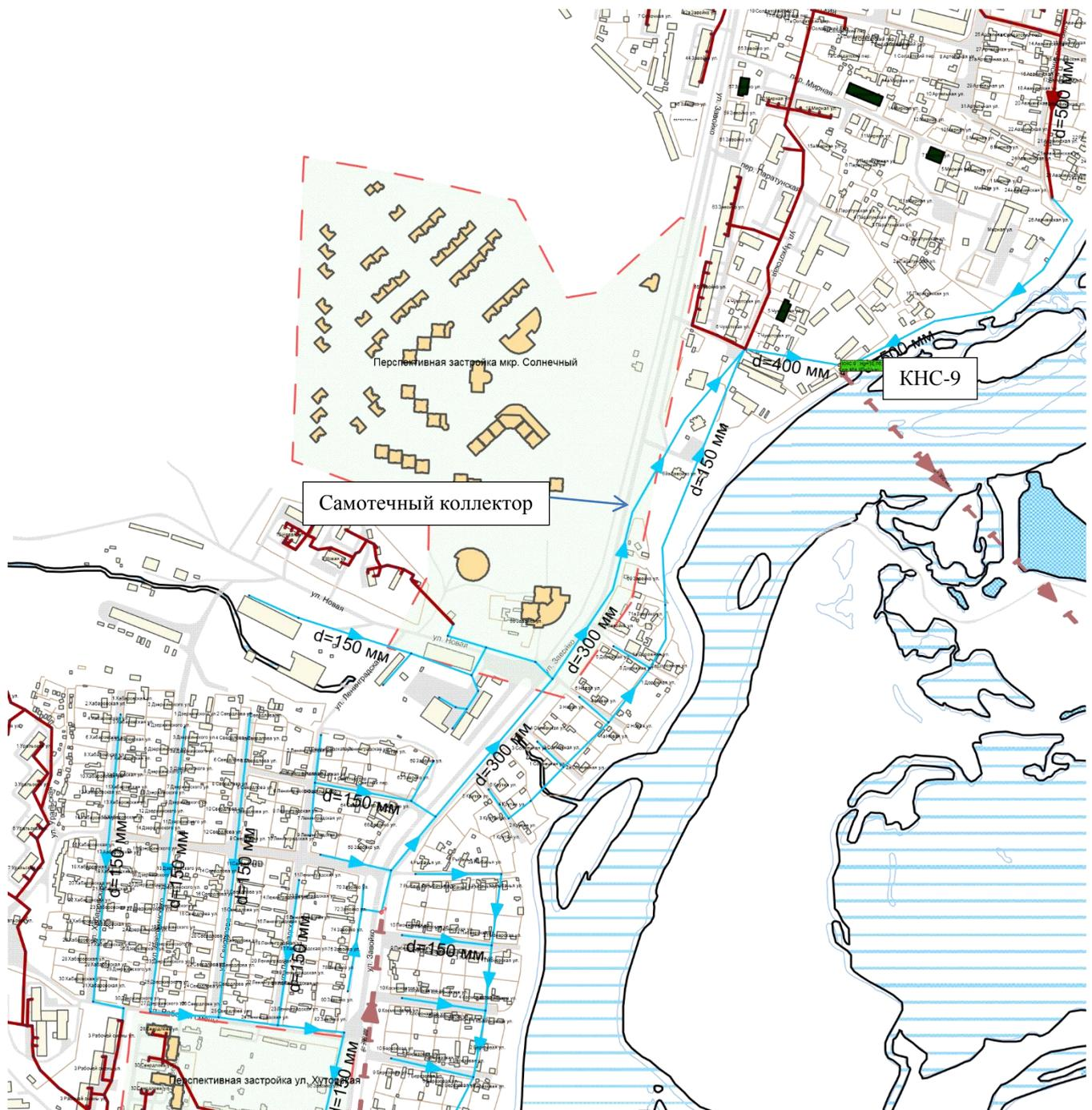
Рисунок 7.5. Расположение самотечного коллектора к КНС-9 в модели
