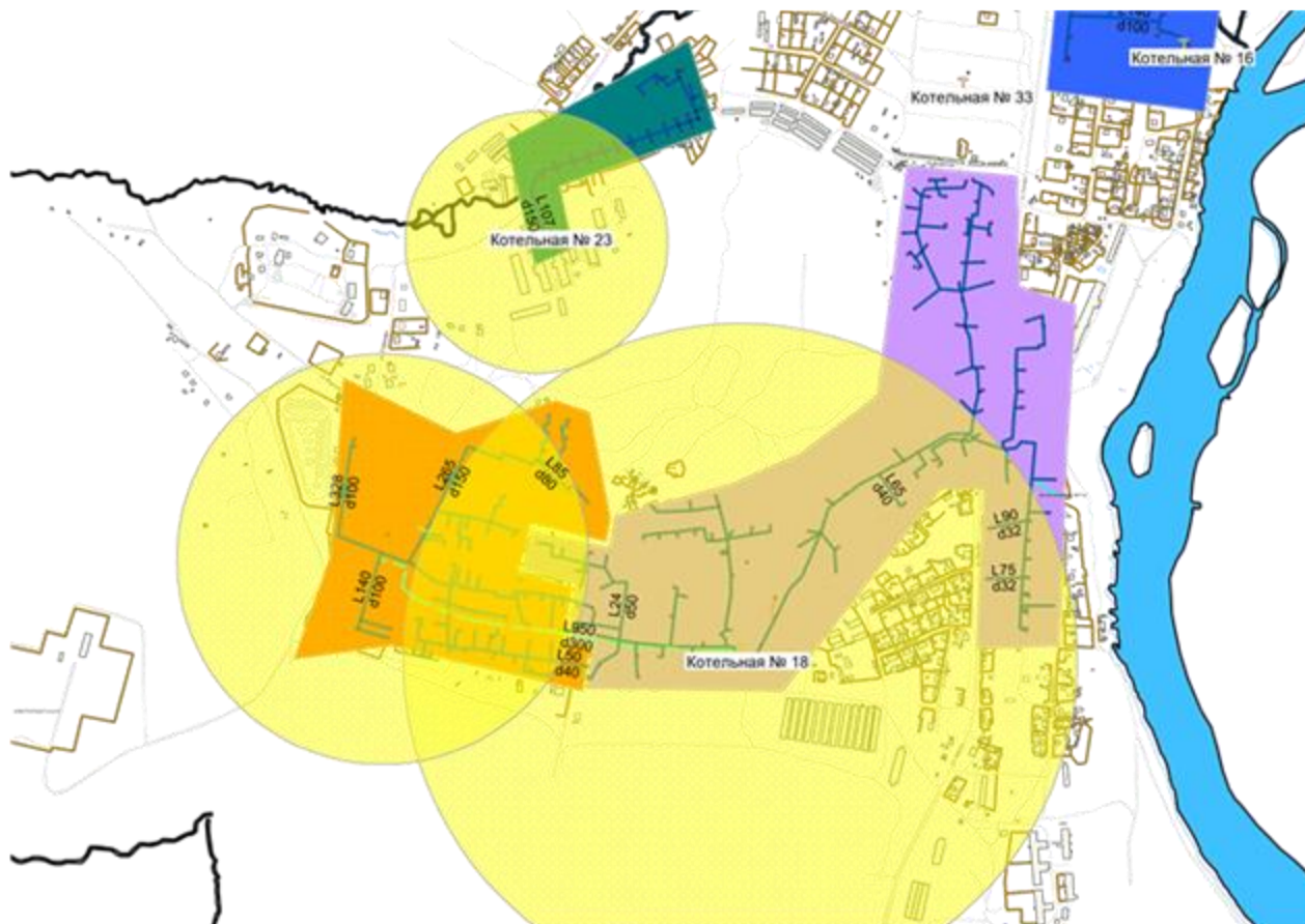
Рисунок 2.18. Радиусы эффективного теплоснабжения котельных №№ 17, 18, 23
