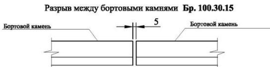
Примечание: предусмотреть разрывы 5мм между бортовыми камнями через каждые 3м (через каждые 3 бортовых камня) для отвода ливневых стоков
