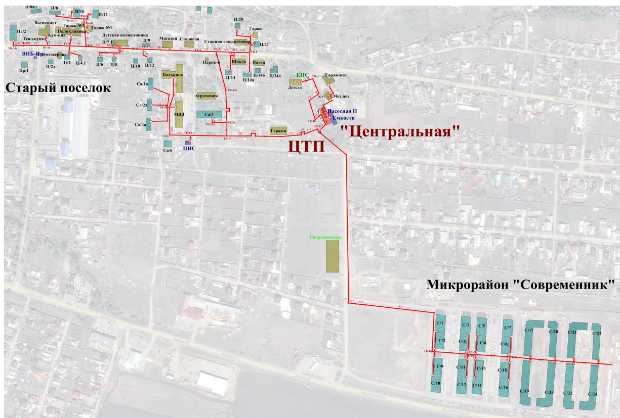
Рис. 1-1. Принципиальная схема теплоснабжения п. Дзержинск (Система теплоснабжения "Центральная")
