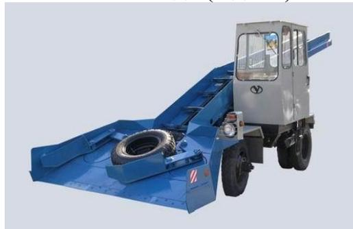
Рис. 3.12. Лаповый снегопогрузчик КО-206.
