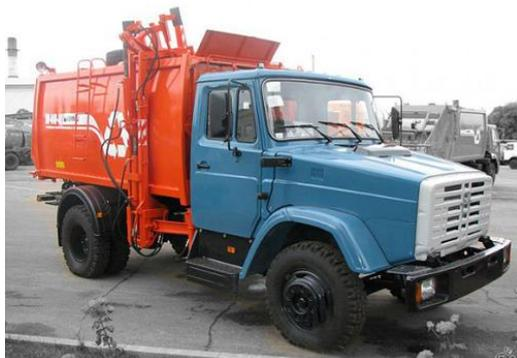
Рис. 3.16. Мусоровоз с боковой загрузкой КО-440-4 на базе шасси ЗИЛ-433362
