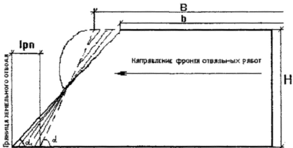
**Рис.4.34. Технологическая схема выполаживания откоса свалок**
