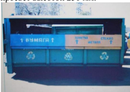
**Рис. 4.16. Контейнер для селективного сбора отходов большого объема.**
