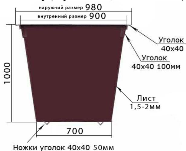
**Рис. 4.22. Стандартные металлические контейнеры емкостью 0,75 м<sup>3</sup>**
