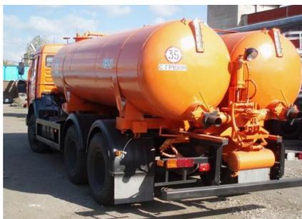
**Рис. 3.17. Вакуумная машина КО-505А на шасси КамАЗ-65115-71**
