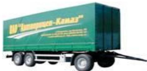
Рис. 4.12. Тентовый прицеп бортовой СЗАП 8353
