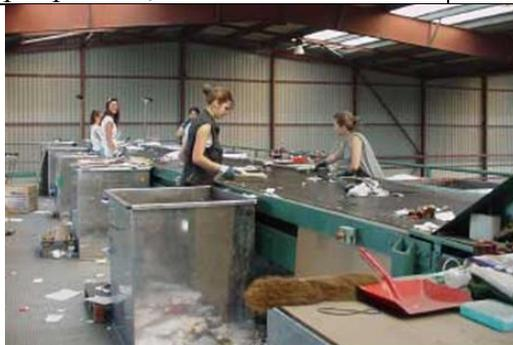
**Рис. 4.5. Конвейер подающий сортировочный**
