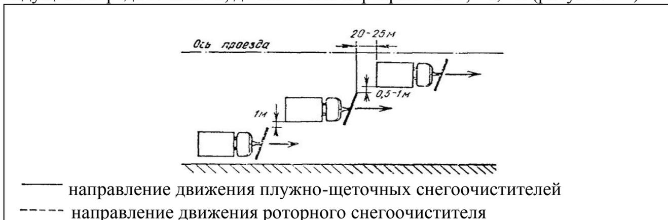
**Рис. 3.7. Схема расчистки проезжей части улиц колонной плужно-щеточных снегоочистителей и складирование снега в лотке**
