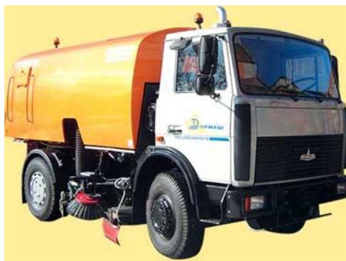
**Рис. 3.10. Вакуумная подметально-уборочная машина ВПМД-01.**
