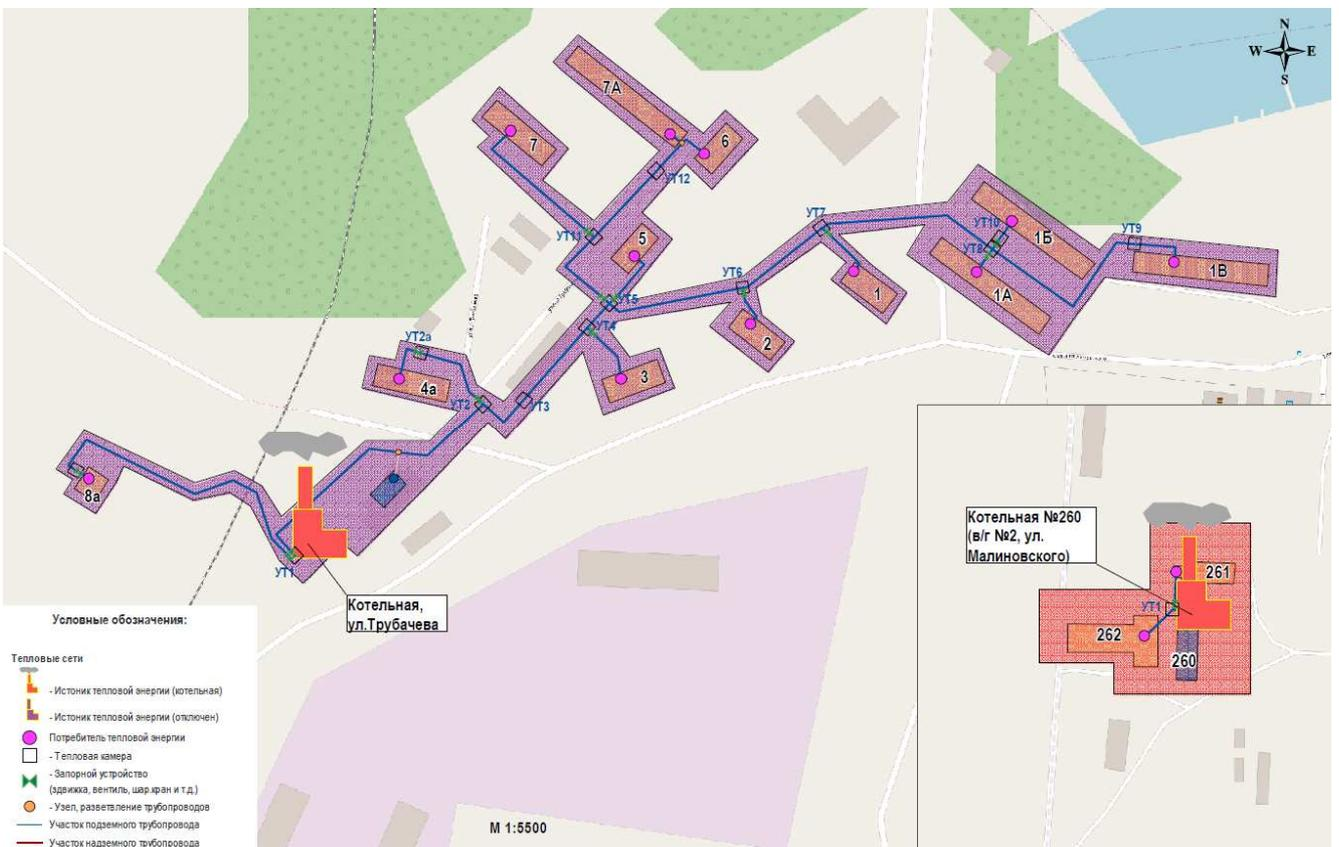
Рис. 3.6. Существующие зоны действия систем теплоснабжения и источники тепловой энергии – котельные на ул. Трубачева и Малиновского.
