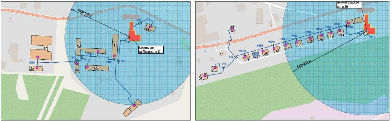
Рис. 3.2. Схема радиусов эффективного теплоснабжения от котельных на ул. Ленина и Ленинградское ш.
