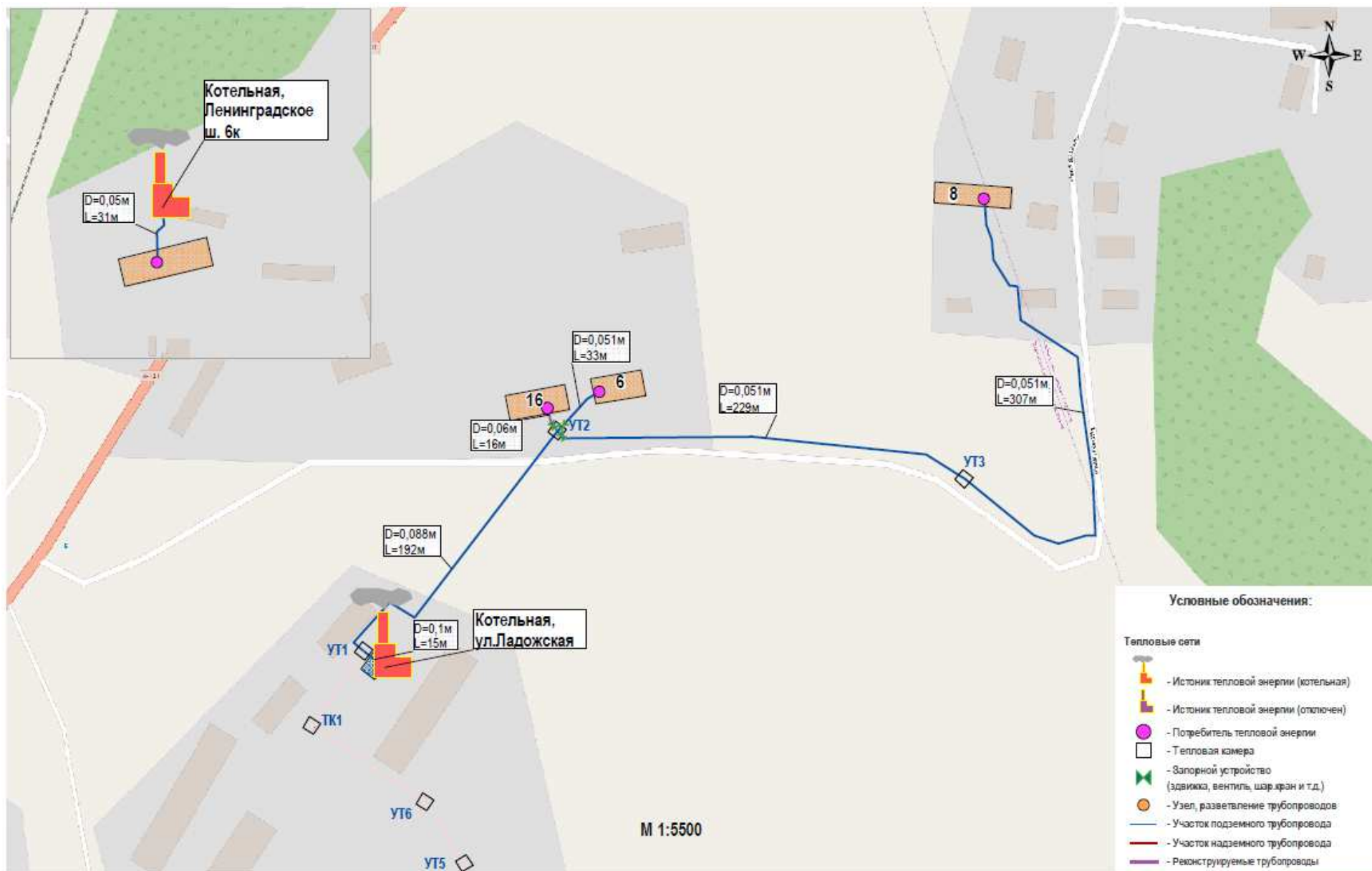
Рис. 4.3. Перспективный режим работы тепловых сетей котельных, ул. Ладужская и Ленинградское ш., 6б.
