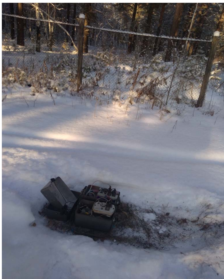
Рис. 12.4. Трёхкомпонентная цифровая сейсмическая станция Байкал-7HR с пьезоэлектрическим акселерометром А1638.
