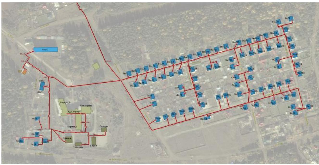
**Рис. 3-4. Фрагмент электронной модели схемы теплоснабжения МГЦ и ТСЖ «Маркова-2»**
