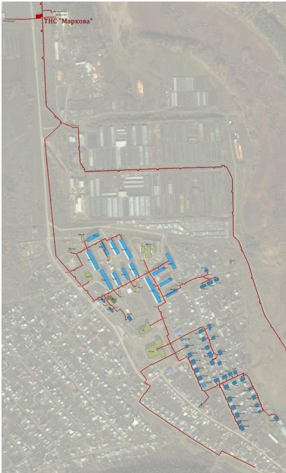
**Рис. 3-3. Фрагмент электронной модели схемы теплоснабжения п. Маркова**
