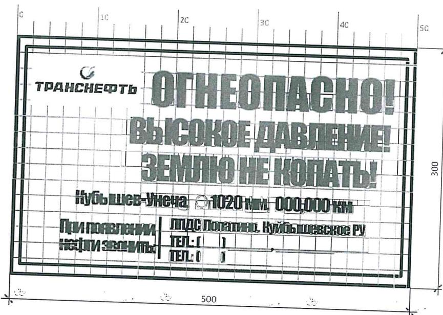
Рисунок 3 – Щит-указатель с предупреждающим знаком «Огнеопасно! Высокое давление! Землю не копать!»
