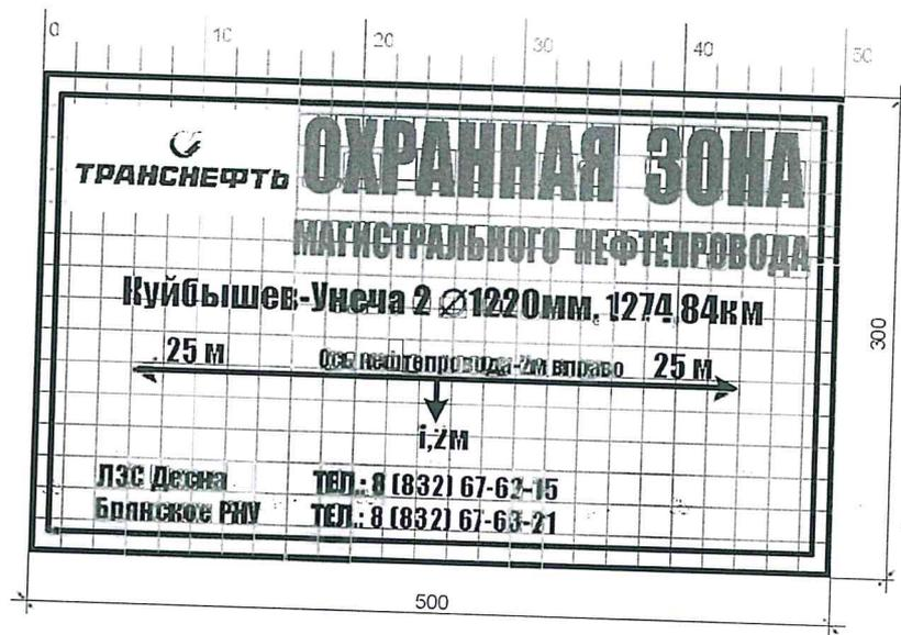
Рисунок 1 – щит-указатель с опознавательным знаком «Охранная зона»
