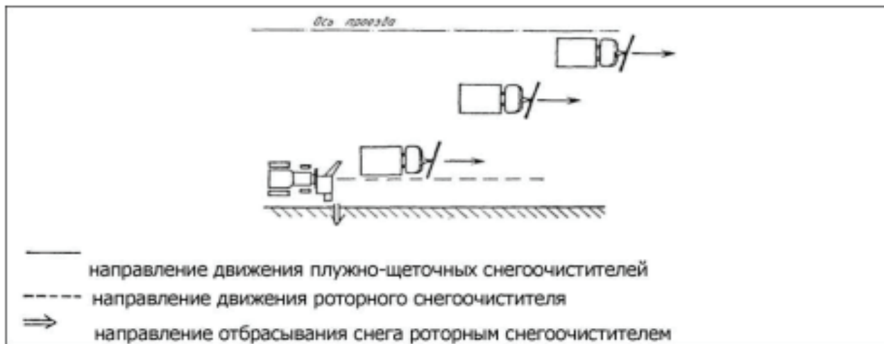
Рисунок 9 – схема расчистки проезжей части улиц колонной плужно-щеточных снегоочистителей и перекидывание снега роторным снегоочистителем.
