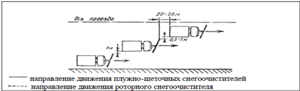
Рисунок 8 – Схема расчистки проезжей части улиц колонной плужно-щеточных снегоочистителей и складирование снега в лотке.
