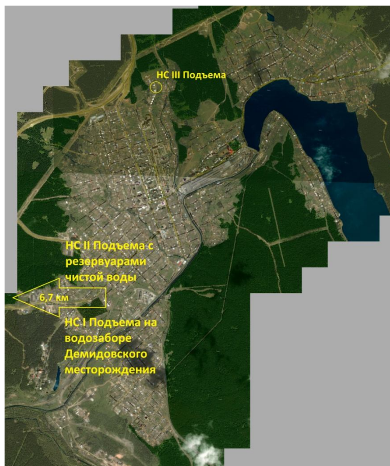
Рис. 4. Схема расположения насосных станций Фактическая среднечасовая нагрузка равна 80% от номинала.
