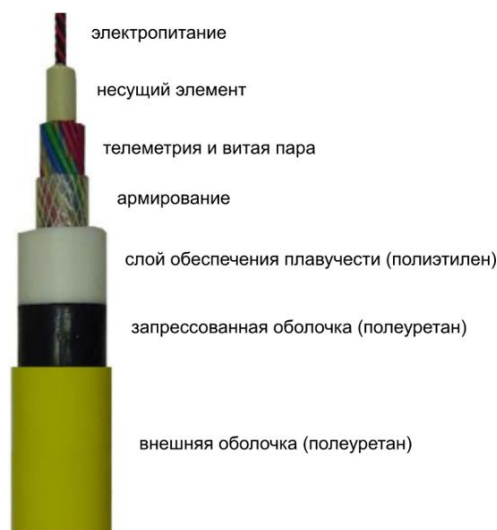
Рисунок 3.6-3. Конструкция кабеля сейсмической косы Sercel SEAL Sentinel Solid Streamer
