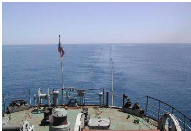
Рисунок 3.6-5. Буксировка приемной и питающей линий
