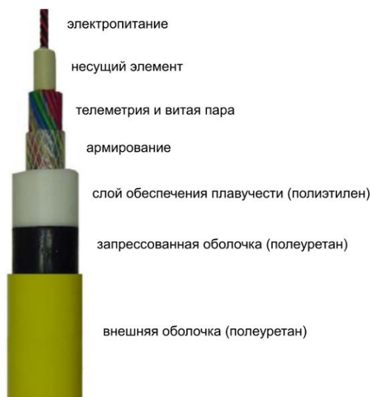
Рисунок 5.1-3. Конструкция кабеля сейсмической косы Sercel SEAL Sentinel Solid Streamer
