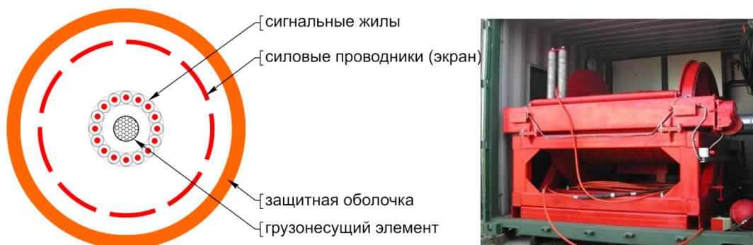
Рисунок 5.2-3. Конструкция питающего кабеля (слева), катушка с питающим кабелем (справа)
