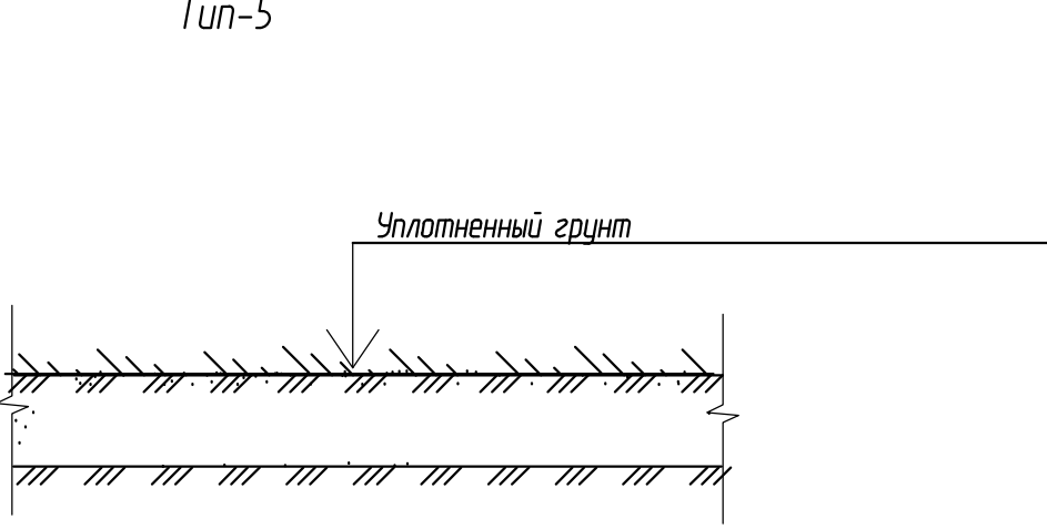
КОНСТРУКЦИЯ ПЛОЩАДКИ СКЛАДИРОВАНИЯ
