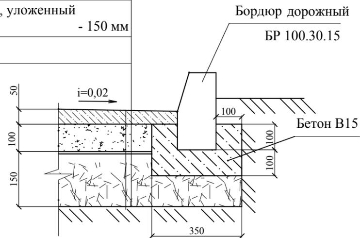
**Конструктивный разрез тротуара - Тип II**
