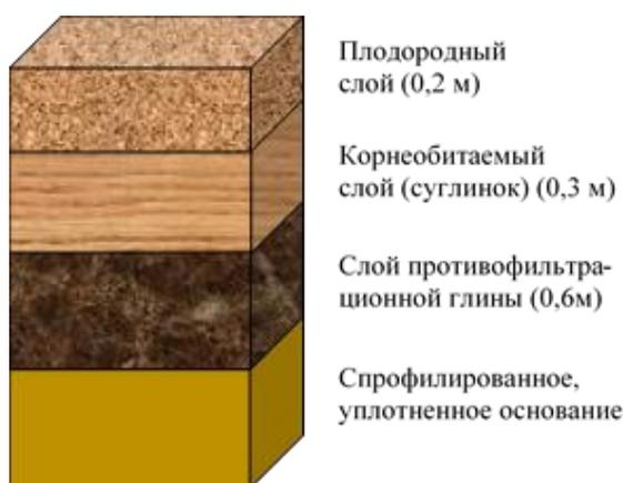
Рисунок 1. Структура противofильтрационного экрана
